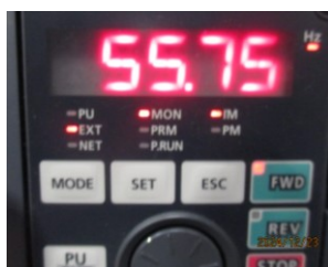
インバーター出力≒56Hz
