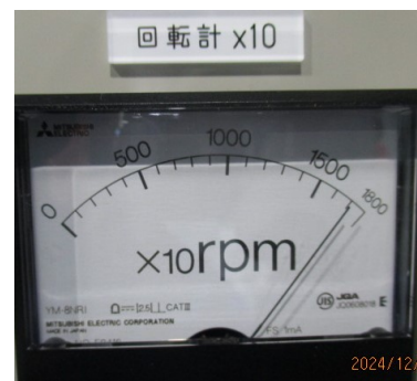
回転計(約17000RPMの時)
